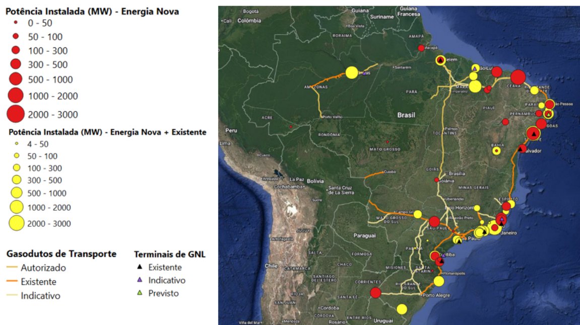
Figura 7 – Localização das usinas termelétricas: capacidade instalada e novas contratações no LRCAP 2026
